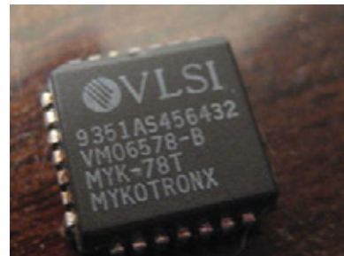
Historischer Clipper-Chip der NSA (Foto: Travis Goodspeed)
